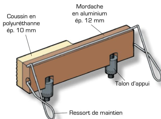
Les mordaches en **aluminium**, forment un **prisme précis** qui possède des formes en V pour le serrage de petites pièces (vé vertical, vé horizontal et vé oblique à 45°).
