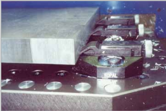
Usinage de plateau en aluminium avec des Mini-pousseurs sur supports spéciaux
